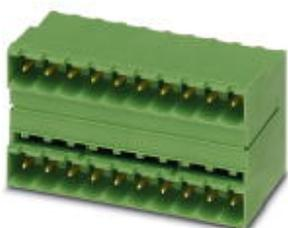
Корпусная часть для печатных плат, номинальный ток: 10 А, полюсов: 16, размер шага: 5 мм, цвет: зеленый, поверхность контакта: Золото, монтаж: Пайка волной припоя, Применяется вместе со штекерными частями MVSTB или FKCV и штекерами MVSTBW (или FKCVW соответственно) и MVSTBR (FKCVR). Нельзя использовать со штекерными частями TMSTBP!
