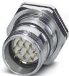
Приборный соединитель, задняя часть стенки, прямой, экранирован.: есть, Винтовой зажим, M23, Полюсов: 6+3, тип контактов: Штифт, Выводы под пайку, Аксиальное уплотнительное кольцо, Центральное крепление M25 x 1,5, Толщина стенок, мин.: 0,8 мм, Толщина стенок, макс.: 6,5 мм
