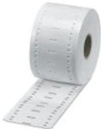
Маркер для кабелей, рулон, белый, без маркировки, маркируется с помощью: THERMOMARK ROLLMASTER 300/600, THERMOMARK X1.2, THERMOMARK ROLL X1, THERMOMARK ROLL 2.0, THERMOMARK ROLL, тип монтажа: Монтаж кабельной стяжкой, диаметр кабеля: ≥ 6 мм, размер маркировочного поля: 55 x 15 мм
