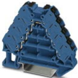
Распределитель потенциала, без нажимной кнопки, номинальное напряжение: 250 В, номинальный ток: 17,5 А, сечение: 0,14 мм<sup>2</sup> - 2,5 мм<sup>2</sup>, AWG: 14 - 26, тип подключения: Зажимы Push-in, полюсов: 2, количество подключений: 16, ширина: 8,3 мм, длина: 64 мм, цвет: синий, цвет элементов подключения: черный, монтаж: NS 35/7,5, NS 35/15
