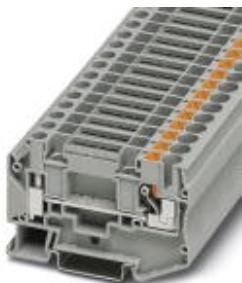
Проходные клеммы, тип подключения: Зажимы Push-in, Винтовые зажимы, сечение: 0,5 мм<sup>2</sup> - 10 мм<sup>2</sup>, AWG: 20 - 10, ширина: 8,2 мм, цвет: серый, монтаж: NS 35/7,5, NS 35/15
