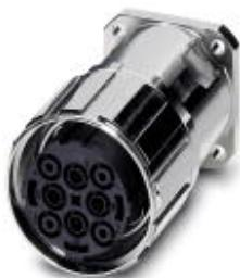
Приборный соединитель, передняя часть стенки, с накатанной гайкой, прямой, Винтовой зажим, M40, полюсов: 4+3+PE, тип контактов: Розетка, Обжим, Аксиальное уплотнительное кольцо, 4x Ø4,2, экранирован.: есть, размер фланца: 40 мм x 40 мм, диапазон диаметра кабеля: 0 мм ... 0 мм
