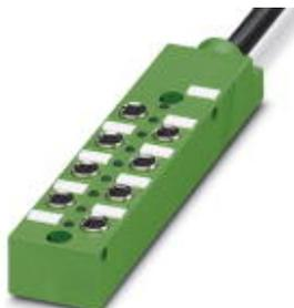
Коробка датчика и исполнительного элемента, применение: Стандартн., тип подключения: Розетка M8 металл, количество гнезд: 8, полюсов: 3, механические ключи: А - стандарт, гнездо для платы: один ряд, индикатор состояния: есть, р-п-р; подключение магистрального кабеля: Жесткое подключение 180°, PUR/PVC, длина кабеля: 10 м, экранировка: нет
