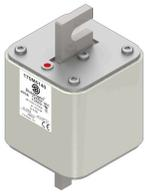
Предохранитель, высокая скорость, 400 А, AC 1250 V, size 3, 76 x 90 x 139 мм, aR, DIN, IEC, одинарный индикатор
