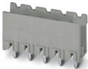
Корпусная часть для печатных плат, номинальный ток: 12 A, расчетное напряжение (III/2): 320 В, полюсов: 24, размер шага: 5,08 мм, цвет: сигнальный серый, поверхность контакта: олово, монтаж: Пайка волной припоя
