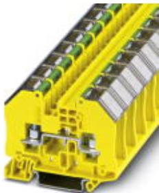
Клемма заземления с зажимами на болтах и прозрачной крышкой для защиты от прикосновений, сечение: 0,1 - 6 мм<sup>2</sup>, AWG: 26 - 10, ширина 16,3 мм, цвет: желто-зеленый
