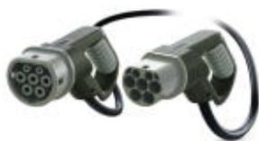
Мобильный зарядный кабель перем. тока с автомобильным зарядным и инфраструктурным штекерами, с защитными колпачками, Designline 1, Тип 2, МЭК 62196-2, 20 A / 480 В (AC), тип конструкции D-Line, кабель: 12 м, черный, прямой, ВНИМАНИЕ: емкость между CP и PE превышает нормативное требование 1500 пФ., поверхность сопряжения: серый, область захвата: серый
