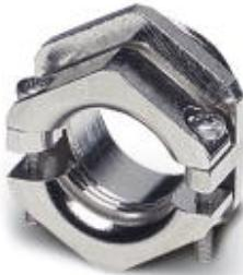
Прижимная винтовая деталь, с зажимом для уменьшения растягивающего усилия, из латуни с медным покрытием, для зажимов 10...14 мм, тип Pg13,5
