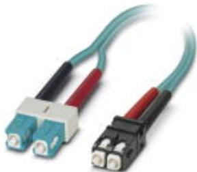
Подготовленный оптоволоконный кабель, кабель Zipcord, многомодовое стекловолокно 50/125 мкм, OM3, штекеры: SC-Duplex / SC-RJ, класс защиты: IP20, для прокладки в кабельных каналах или электрошкафах, длина: 1 м
