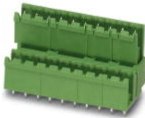
Корпусная часть для печатных плат, номинальный ток: 10 A, расчетное напряжение (III/2): 320 В, полюсов: 12, размер шага: 5 мм, цвет: зеленый, поверхность контакта: олово, монтаж: Пайка волной припоя, Для монтажа в ряд Крепежный фланец: артикул № 1836477, 1836480. Вместе со штекерными частями MVSTB или FKCV должны использоваться штекеры MVSTBW (или FKCVW) и MVSTBR (или FKCVR). Не допускается использовать со штекерными частями TMSTBP!
