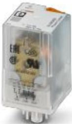
Вставное восьмиконтактное реле с силовыми контактами, 2 переключающих контакта, испытательная кнопка, механическая индикация положения включения, напряжение на катушке: 24 В AC
