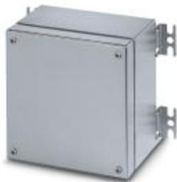
Клеммная коробка, материал: Высококачественная сталь 316L / 1.4404, поверхностное сопротивление: сатинированный, серебристый, 300 мм x 300 мм x 120 мм, тип замка: навинчиваемая крышка, комплект поставки - ATD: Монтажная плата, Крепежный кронштейн в комплекте с винтами, Штифты заземления M12, расположенные снаружи, Инструкция по монтажу, Монтажная плата
