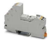
Релейный блок RIF-1..., для миниатюрного силового реле с 1 или 2 переключающими контактами или полупроводникового реле аналогичной конструкции, разъем Push-in, возможность установки входных модулей или модулей подавления помех, для монтажа на NS 35/7,5
