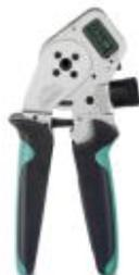
Клещи для опрессовки, для точечных контактов, универсальная настройка сечения от 0,08 до максимум 2,5 мм<sup>2</sup>, с цифровым индикатором, ширина шага 0,01 мм, возможность отмены принудительной блокировки, боковое введение, включая устройство для позиционирования
