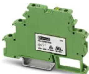
Клеммный модуль с реле, со впаянными мощным миниатюрными реле, материал контактов AgSnO: для коммутации различных нагрузок (от средних до больших), 1 переключающий контакт, входное напряжение 24 В DC, монтируются на NS 35/7.5, ширина клеммного модуля 6,2 мм
