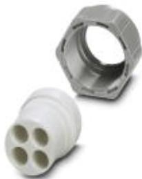
Резьбовой сальник Pg21 с частично нарезанной резьбой, пластмассовый, в комплекте с резиновым уплотнением с несколькими отверстиями (4 x 8 мм) и прижимной винтовой деталью, для корпусов исполнения 2-4
