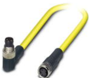
Кабель для датчика / исполнительного элемента, 3-полюсн., ПВХ, желтый, Штекеры угловой M8, к Гнездо прямое M8, длина кабеля: 0,5 м
