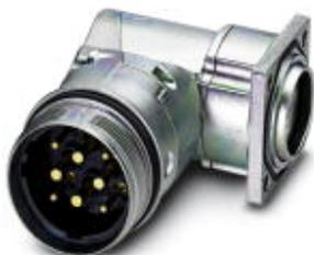
Аппаратн. соединитель, передняя стенка, угловой, поворотный, для стандартной блокировки и SPEEDCON, M40, полюсов: 4+3+PE, тип контактов: Штифт, Обжим, Аксиальное уплотнительное кольцо, 4xØ4,4, экранирован.: есть, размер фланца: 40 мм x 40 мм
