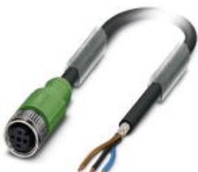
Кабель для датчика / исполнительного элемента, 3-полюсн., PUR без галогенов, темно-серый RAL 7021, экранирован., свободный конец, к Гнездо прямое M12, А-кодирование, длина кабеля: 10 м
