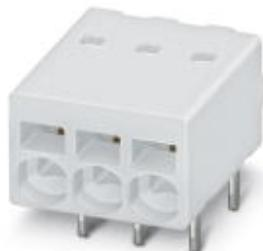
Клеммы для печатной платы, номинальный ток: 6 А, номинальное напряжение: 160 В, размер шага: 2,5 мм, полюсов: 7, тип подключения: Пружинные зажимы Push-in, монтаж: THR пайка, направление подключения, проводник/печатная плата: 0 °, цвет: белый
