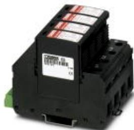
Вставной молниезащитный разрядник на базе варистора для 3-фазных сетей электропитания TN-S с отдельными проводниками N и PE (5-проводная система: L1, L2, L3, N, PE), для классов молниезащиты III и IV, с контактом устройства дистанционной сигнализации.
