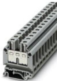
Проходные клеммы, номинальное напряжение: 690 В, номинальный ток: 70 А, тип подключения: Винтовые зажимы, количество точек подсоединения: 2, сечение: 0,5 мм<sup>2</sup> - 16 мм<sup>2</sup>, AWG: 20 - 6, ширина: 10,2 мм, цвет: серый, тип монтажа: NS 35/7,5, NS 35/15, NS 32
