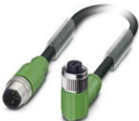
Кабель для датчика / исполнительного элемента, 3-полюсн., PUR без галогенов, темно-серый RAL 7021, экранирован., Штекеры прямое M12, А-кодирование, к Гнездо угловой M12, А-кодирование, длина кабеля: 0,6 м
