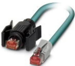
Готовый Ethernet-кабель, экранир., 4 пары, AWG 26, гибкий (7-жильный), RAL 5021 (цвет морской воды), штекер RJ45/IP67, черный, на штекер RJ45/IP20, прямая разводка, длина 5 м
