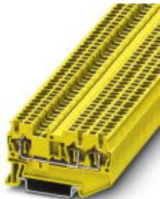
Проходные клеммы, номинальное напряжение: 500 В, номинальный ток: 17,5 А, тип подключения: Пружинный зажим, количество точек подсоединения: 3, сечение: 0,08 мм<sup>2</sup> - 1,5 мм<sup>2</sup>, AWG: 28 - 16, ширина: 4,2 мм, цвет: желтый, тип монтажа: NS 35/7,5, NS 35/15
