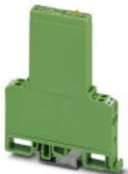
Силовое полупроводниковое реле, со световым индикатором и защитной схемой во выходной и выходной цепи, вход: 12 В пост.тока, выход: 5-36 В пост.тока/макс. 1 А
