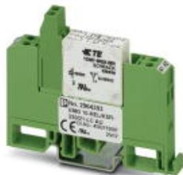
Релейный модуль со впаянными миниатюрными реле, позолоченный контакт для небольших нагрузок, 1 переключающий контакт, входное напряжение 230 В AC/DC
