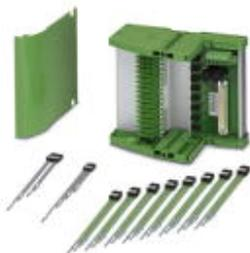
Универсальный конечный носитель для подключения 16 разделительных усилителей MINI Analog к цифровым или аналоговым входным-выходным платам, с помощью штекерного разъема D-SUB, 37-полюсный (соединение 1:1)
