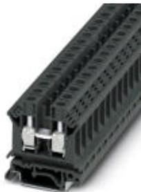
Проходные клеммы, номинальное напряжение: 800 В, номинальный ток: 57 А, тип подключения: Винтовые зажимы, количество точек подсоединения: 2, сечение: 1,5 мм<sup>2</sup> - 16 мм<sup>2</sup>, AWG: 16 - 6, ширина: 10,2 мм, цвет: темно-серая, тип монтажа: NS 35/7,5, NS 35/15, NS 32
