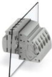
Проходная клемма, тип подключения: Пружинные зажимы Push-in, Винтовые зажимы, полюсов: 1, ток нагрузки: 76 А, сечение: 1,5 мм<sup>2</sup> - 16 мм<sup>2</sup>, AWG 14 - 4, угол между направлениями подключения провода и установки разъема: 45°, ширина: 12 мм, цвет: серый
