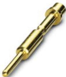
Обжимной контакт, с разворотом, Отдельный контакт, диаметр контакта: 1 мм, диапазон обжима: 0,06 мм<sup>2</sup> ... 0,25 мм<sup>2</sup>
