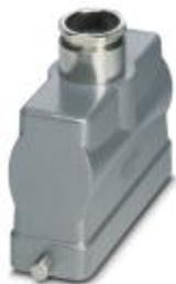
Сальниковый корпус HEAVYCON B24, для крепления одной защелкой, высота 76 мм, с резьбовым соединением 1x M32, прямой ввод кабеля
