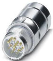
Переходные соединители, прямой, короткий, Крепление SPEEDCON, M23, полюсов: 4+3+PE, тип контактов: Штифт, Обжим, экранирован.: есть, диапазон диаметра кабеля: 7,5 мм ... 14 мм
