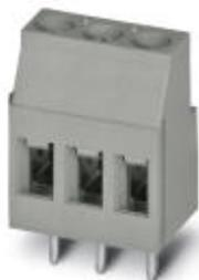
Клеммы для печатной платы, номинальный ток: 24 А, номинальное напряжение: 400 В, размер шага: 5,08 мм, полюсов: 11, тип подключения: Винтовой зажим с натяжной гильзой, монтаж: Пайка волной припоя, направление подключения, проводник/печатная плата: 0°, цвет: сигнальный серый
