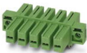
Корпусная часть для печатных плат, номинальный ток: 41 А, расчетное напряжение (III/2): 630 В, полюсов: 12, размер шага: 7,62 мм, цвет: зеленый, поверхность контакта: олово, монтаж: Пайка волной припоя
