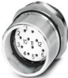
Приборный соединитель, передняя часть стенки, прямой, экранирован.: есть, для стандартной блокировки и SPEEDCON, M23, Полосов: 12, тип контактов: Розетка, Подключение пайкой, Осевое уплотнение, Центральное крепление Pg13,5
