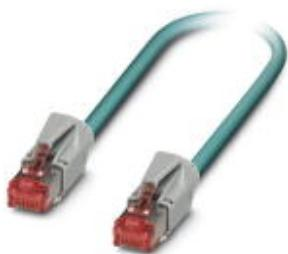
Готовый кабель Ethernet, CAT5e, экранированный, 2-парный, AWG 26\*, гибкий (7-жильный), RAL 5021 (цвет морской воды), штекер RJ45/IP20 на штекер RJ45/IP20, прямая разводка, длина 1,5 м
