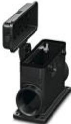
Приборный корпус B24, крепление двумя защелками, материал: PA, материал, защитная крышка: PA, длина кабеля: 2, боковое, высота: 84 мм, кабельный ввод: без, патрубок: Нет, 2x M32, защитная крышка: да, Стандартн., включая 2 резервных адаптера
