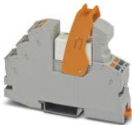
Предустановленный релейный модуль с разъемами push-in, состоящий из: установочного блока (основания), реле с силовыми контактами, вставного индикатора/подавителя помех и фиксатора. Исполнение контакта: 1 переключающий. Входное напряжение: 12 В DC
