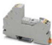
Релейный блок RIF-1..., для миниатюрного силового реле с 1 или 2 переключающими контактами или полупроводникового реле аналогичной конструкции, разъем Push-in, возможность установки входных модулей или модулей подавления помех, для монтажа на NS 35/7,5
