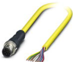
Кабель для датчика / исполнительного элемента, 8-полюсн., ПВХ, желтый, Штекеры прямое M12 SPEEDCON, A-кодирование, к свободный конец, длина кабеля: 5 м
