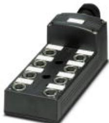
Коробка датчика и исполнительного элемента, применение: Внешние области, тип подключения: Розетка M12 металл, количество гнезд: 8, полюсов: 5, механические ключи: А - стандарт, гнездо для платы: Двойной, индикатор состояния: Нет, Универсальный; подключение магистрального кабеля: вставные винтовые клеммы 180°, экранировка: нет
