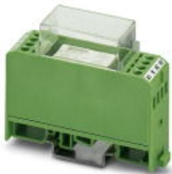
Релейный модуль с миниатюрными реле, со встроенной схемой управления на базе n-p-n-транзисторов, для малых управляющих токов, материал контактов AgNi: для коммутации нагрузок от средних до высоких, 1 переключающий контакт, управл. напряжение 24 В DC
