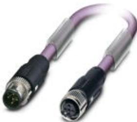
Системный кабель шины, CANopen®, DeviceNet™, 5-полюсн., PUR без галогенов, фиолетовый RAL 4001, экранирован., Штекеры прямое M12 SPEEDCON, А-кодирование, к Гнездо прямое M12 SPEEDCON, А-кодирование, длина кабеля: 1 м
