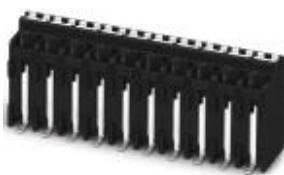
Клеммы для печатной платы, номинальный ток: 13,5 А, номинальное напряжение: 160 В, размер шага: 3,81 мм, полюсов: 7, тип подключения: Пружинные зажимы Push-in, монтаж: SMD пайка, направление подключения, проводник/печатная плата: 90 °, цвет: черный. В наличии образцы в количестве SAMPLE SPT...
