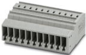
Соединитель COMBI, номинальное напряжение: 500 В, номинальный ток: 24 А, тип подключения: Пружинный зажим, количество точек подсоединения: 1, полюсов: 11, сечение: 0,08 мм<sup>2</sup> - 4 мм<sup>2</sup>, AWG: 28 - 12, ширина: 57,2 мм, высота: 21,8 мм, цвет: серый, тип монтажа: на монтажную пластину
