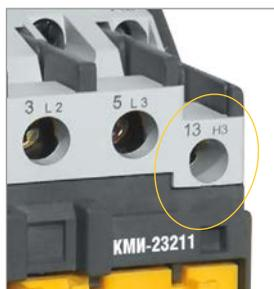
Наличие встроенных дополнительных контактов. Каждый контактор до 32 А комплектуется одним встроенным дополнительным контактом: 1з или 1р (закрывающий или размыкающий). Контакторы от 40 до 95 А комплектуются двумя дополнительными контактами: 1з + 1р.
